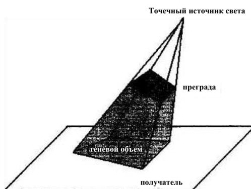
Рис. 3. Принципиальная схема метода теневых объемов.
